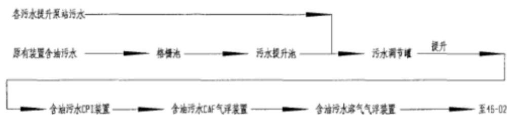
含油污水预处理流程
